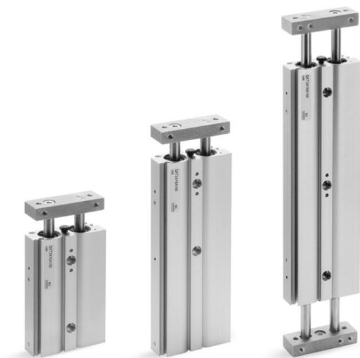
QX系列雙活塞汽缸是一種雙活塞的氣動滑座。氣缸與導引裝置設計在一起，移動部件可承受較大的徑向負載和力矩。雙活塞桿的設計可使汽缸的輸出力提高一倍，很適合安裝在較小的空間，且需要較大輸出力、負載需被導向的工作場合。
